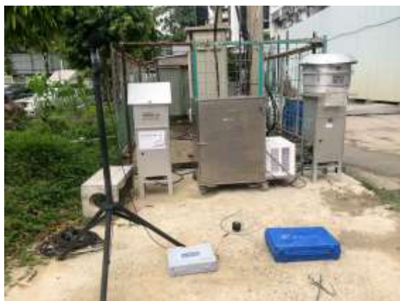
รูปที่ 2-28 แสดงการติดตั้งเครื่องตรวจวัดคุณภาพอากาศ เสียง และความสั่นสะเทือนไว้ในพื้นที่ก่อสร้าง และพื้นที่คณะสาธารณสุขศาสตร์ มหิดล
