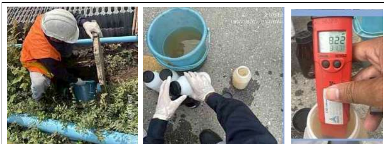
รูปที่ 2-44 แสดงการตรวจวัดคุณภาพน้ำทั้งจากบ่อกักน้ำสุดท้ายก่อนระบายออกสู่ท่อรับน้ำทิ้งสาธารณะ
